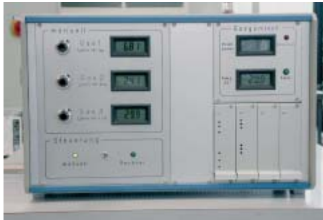
Abb. IV.14-4: Frontansicht der neuen Gasmischapparatur
