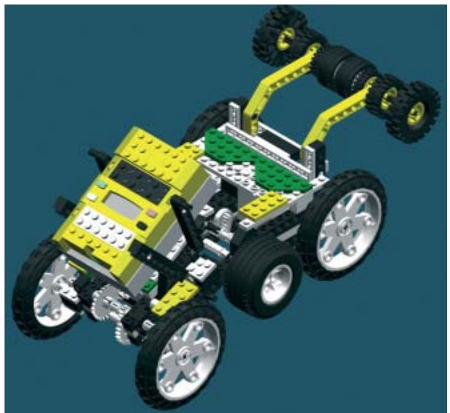
Abb. IV.18-1: CAD-Gesamtansicht des Kletterroboters Graddler. Die elektrischen Verbindungen werden nicht dargestellt.
