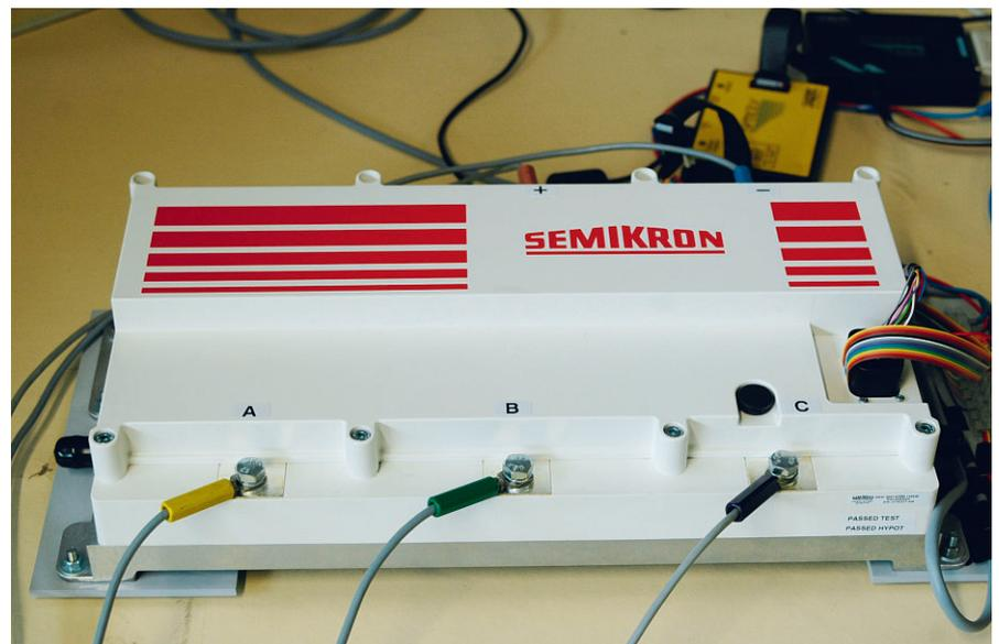
Abb. 1.6-2: Wechselrichter des Hybridantriebs
