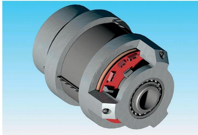
Abb. 1.9-3: Konstruktion des Motors in 3D-Ansicht
