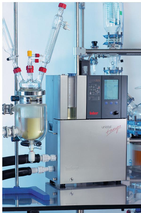
Abb. 1.5-1: Typische Anwendung – Reaktor und Rührer
