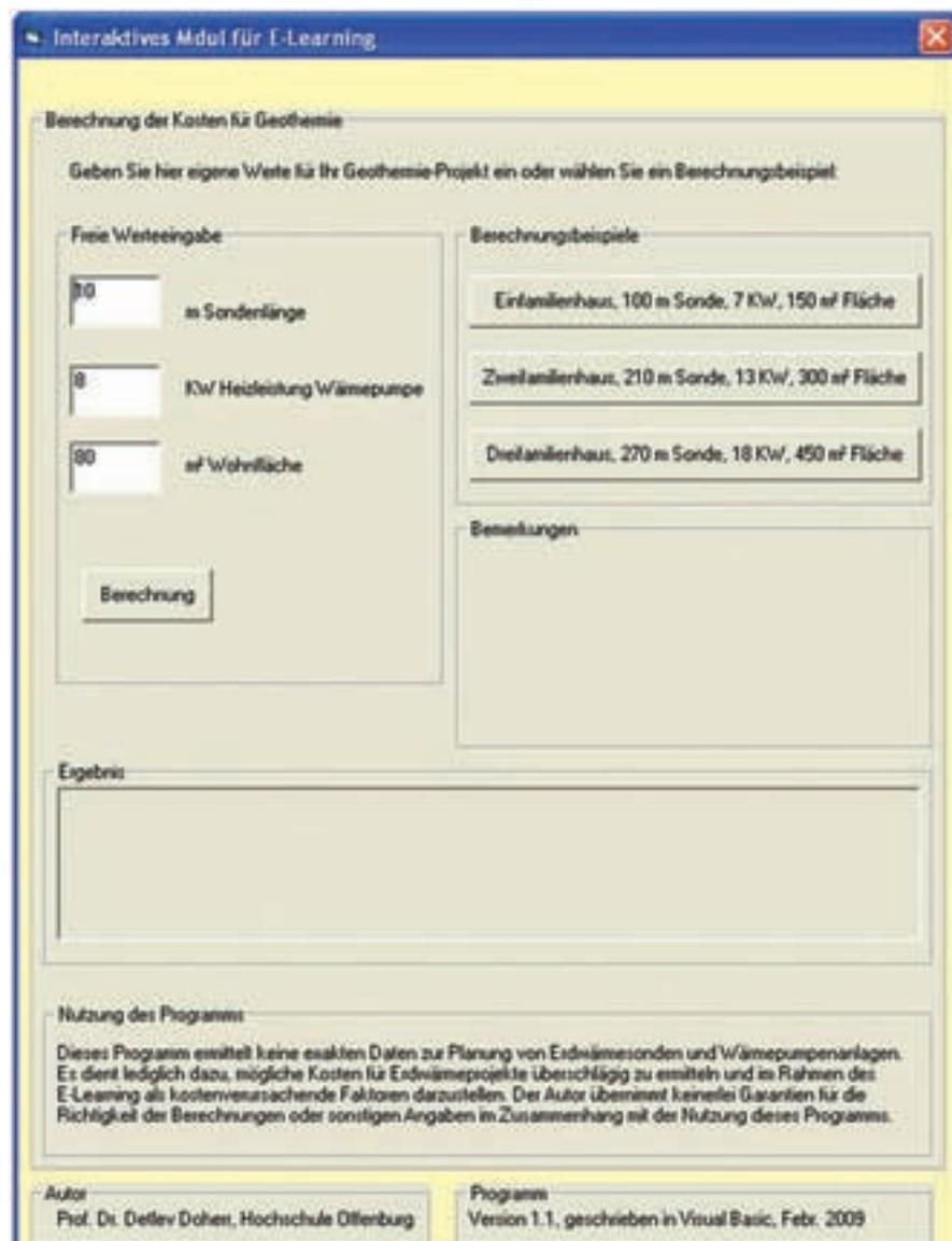
**Abb. 4.4-2:** Berechnungsmodul zum Kostenrahmen für Projekte der oberflächennahen Geothermie anhand von empirischen Werten. Die Berechnungsparameter wurden anhand von publizierten Daten kalkuliert (Siehe [2])
