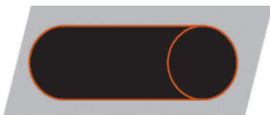
Abb. 1.7-3: Surface-to-Surface-Kontakt zwischen Walze und Fläche
