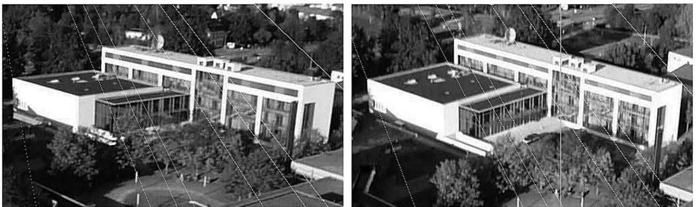
Abb. 2.4-3: Zwei Ausschnitte von Luftbildern der Hochschule Offenburg mit gerechneten 8 Epipolarlinienpaaren, die Berechnung erfolgte in MathCAD
