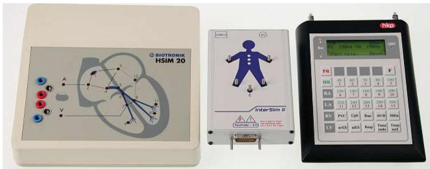
**Abb. 1.3-1:** Drei elektronische Herzrhythmusstimulatoren mit unterschiedlichem Parameterumfang. Von links nach rechts die Geräte HSIM 20 (Biotronik, Berlin), Intersim II (Lang, Chemnitz) und der in diesem Beitrag genutzte ARSI-4 (hkp, Bannewitz) für Ausbildungszwecke und industrielle Simulationen an Herzschrittmachern und Defibrillatoren
