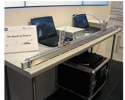
Abb. 2.2-1: „Sprechende Sitzschiene“ – Demonstrator der 3. Generation
