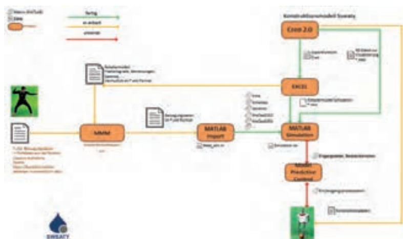
Abb. 2: Aktueller Stand des Datenflusses und der Werkzeuge für die Simulation des Roboters
