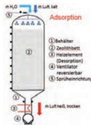
Abb. 1: Prozessschema und Versuchsbehälter im Labor
