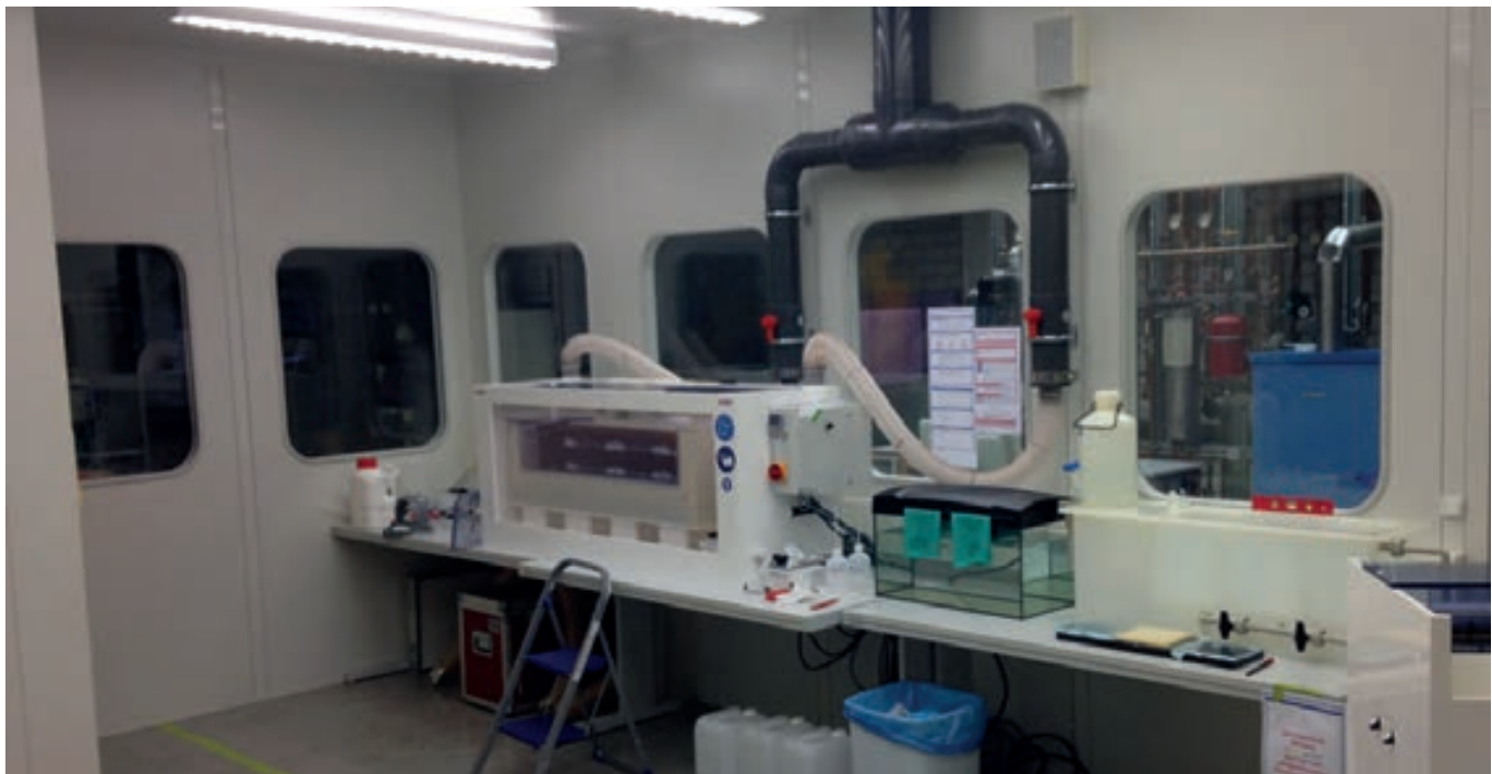
Abb. 2: Nasschemischer Teststand zur Entwicklung neuer Verfahren im Bereich Textur von monokristallinen Siliciumwafern
