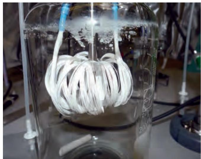
**Abb. 3:** Hohlfaserkapillarmembran zur Wasserstoffzugabe
