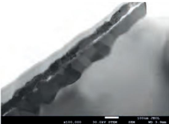
**Abb. 6:** Mit dem JEOL IonSlicer präparierter Solarzellen-Kontakt, STEM-Aufnahme (mit freundlicher Genehmigung von JEOL). Unterschiedliche Kristallorientierungen können erkannt werden
