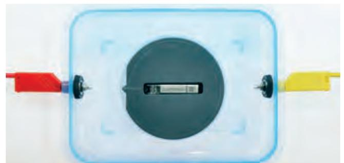
**Abb. 3:** Eventrekorder Reveal LINQ auf einer Drehscheibe mit unterlegtem Winkelmesser im elektrolytischen Trog mit isotonischer Kochsalzlösung und EKG-Einspeisung
