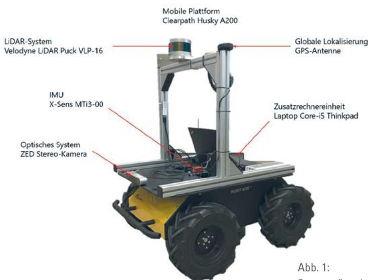
Abb. 1: Systemaufbau, bestehend aus Plattform, Sensorik und Rechereinheit
