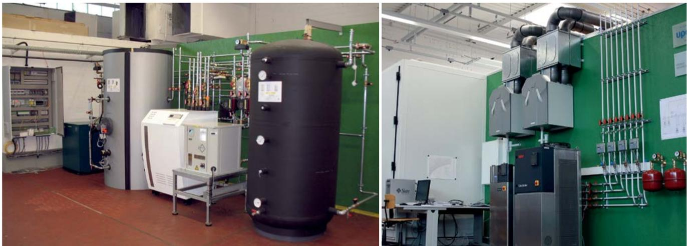
Abb. 1: Ansicht des  $\mu$  KWKK-Labors (v.li.n.re.): Schaltschrank mit Anbindung an das elektrische Microgrid, Blockheizkraftwerk, Wärmespeicher, reversible Adsorptions- und Kompressionskältemaschine und Kältespeicher) mit Messdatenerfassung und Klimakammer (hier mit Prozessthermostaten, rechts)
