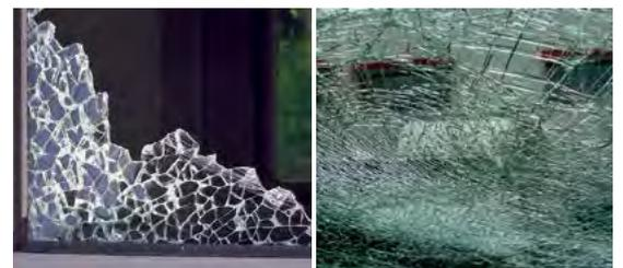
Abb. 3: Anwendungsbeispiele von Sicherheitsglas ESG und VSG, Bruchbild ESG-Sicherheitsglas (li), VSG-Sicherheitsglas nach Bruch (re) (Quelle: wikipedia)
