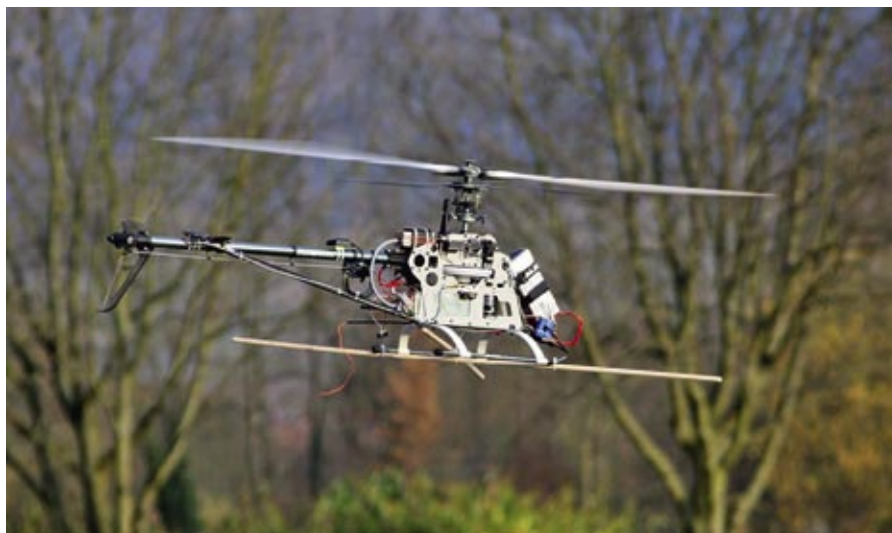
T-Rex 600 mit Avionik im geregelten Flug. Das Kurs-Lagereferenzsystem befindet sich hinter dem Rotorkopf, die Flugrechner und das GPS unterhalb des Getrieberads in einem Metallgehäuse.
