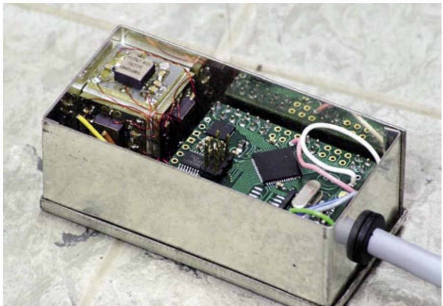
Blick in das geöffnete Kurs-Lagereferenzsystem. Auf dem würfelförmigen Block sitzen drei MEMS-Kreisel und -Beschleunigungsmesser mit Elektronik. Der Rechner, der die Sensordaten in Lagewinkel umrechnet, ist auf der Elektronikkarte zu sehen.
