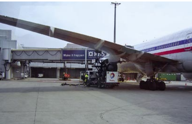
Unterirdische Leitungen liefern den Kraftstoff und mobile Zapfsäulen stellen die Verbindung zum Flugzeug her.
