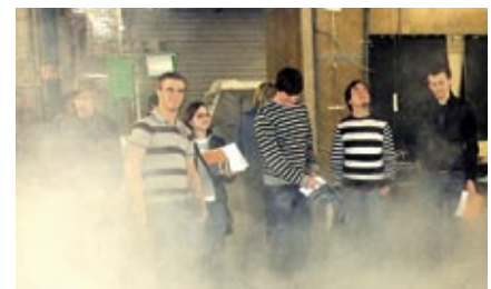
Keine heiße Luft, sondern warmer Rauch zeigt die Luftführung an.
