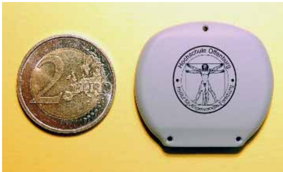
μTRANS, eine Entwicklung am IAF zur Erfassung elektrophysiologischer Daten in Kleintieren mit semipassiver RFID-Technik.
