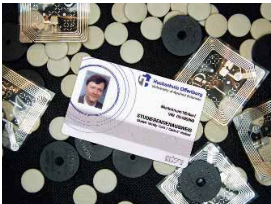
Industrielle RFID-TAGs nach DIN ISO 15693 für Warenkennzeichnung, Wäsche- und Textilidentifikation sowie als Klebeetiketten.
