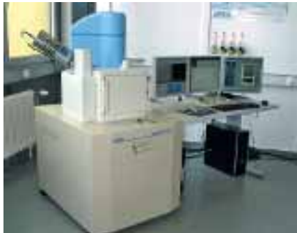
Das neue Raster-Elektronenmikroskop im Zentrum für Physik. Links ist der energiedispersive Röntgendetektor zu sehen.
