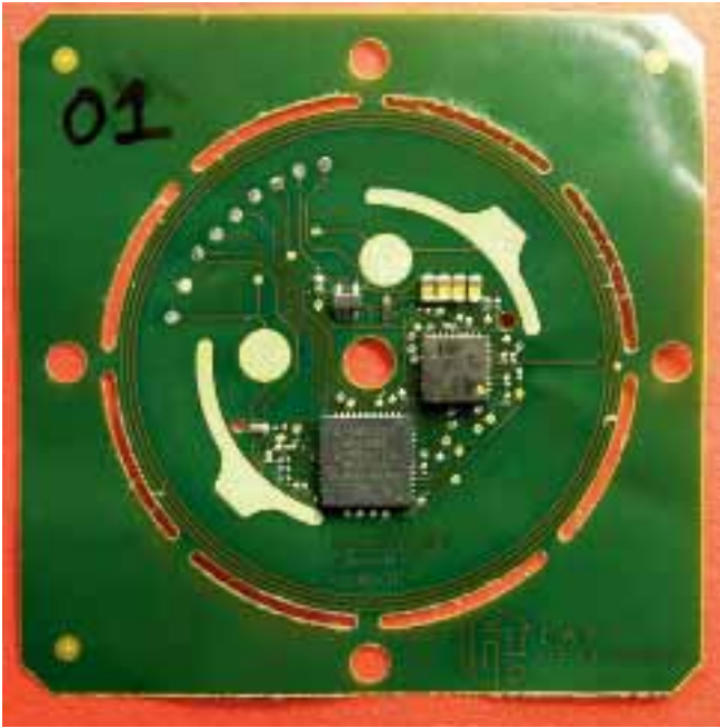
MamoCheck, passives RFID-Überwachungssystem für Brustimplantate, Prototyp vor Verguss, entwickelt am IAF
