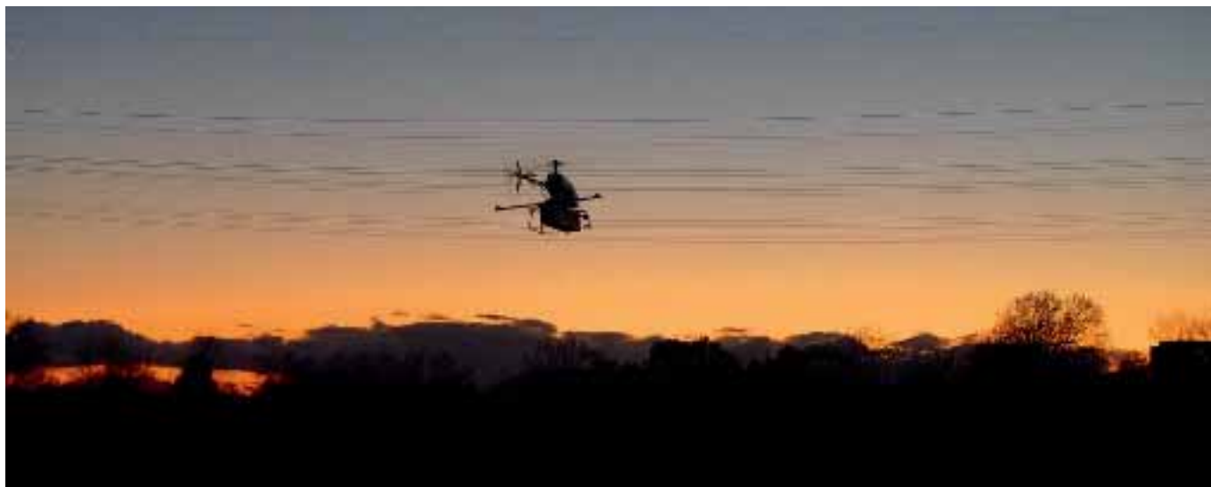
Der acht Kilo schwere Benzinhelikopter steigt zu einem Messflug in den nächtlichen Himmel. Untergehängt hat er eine sechs Kilo schwere Box mit einer inertialen Messeinheit eines kommerziellen Herstellers und das GPS-Trägerphasenmesssystem der Hochschule
