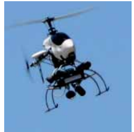
Der Elektrohelikopter mit zwei IP-Kameras und einem 5,8-GHz WLAN Router zur Bildübertragung
