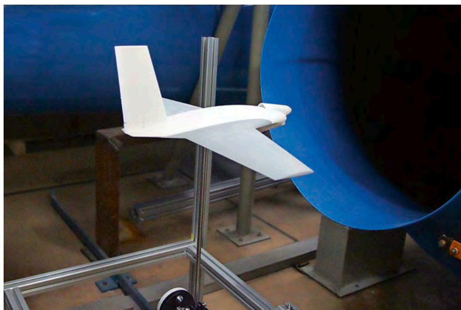
Unlackiertes UAV-Modell während einem Windkanaltest für das Projekt Jan Mayen
