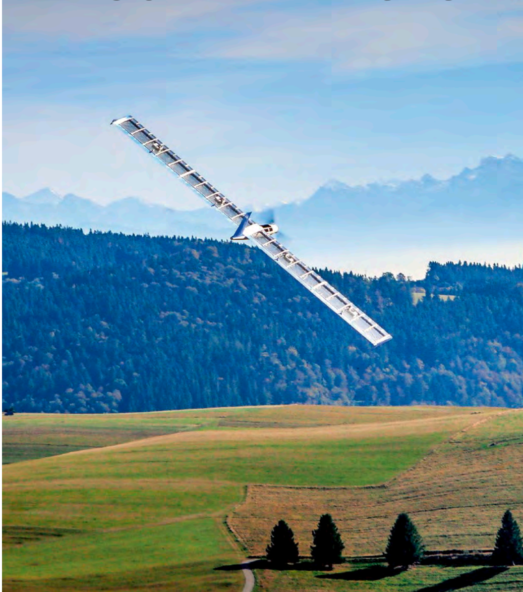
Erfolgreiche Abschluss-Arbeit: Alle Komponenten des UAV „Alf Mark 2“ kommen aus dem 3D-Drucker Foto: Maximilian Keller
