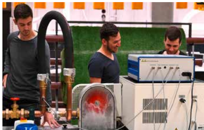
Normalerweise stellen die Studierenden im Rahmen eines Labors am Prüfstand für Wasserturbinen verschiedene Regler nach Vorgaben per Hand ein, um Messwerte für die sogenannte Pelton-Turbine zu bekommen (Foto oben). In der virtuellen Veranstaltung gaben sie die vorgegebenen Drehzahlen und Düsenöffnungen über die Computertastatur ein und der „Digitale Zwilling“ lieferte die gleichen Messwerte wie der reale Prüfstand (Grafik unten)
