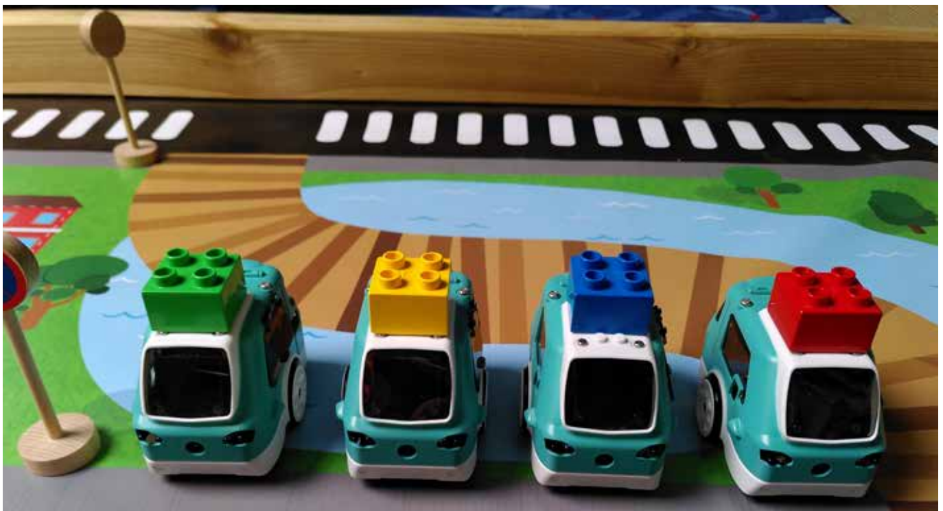
Auf den ersten Blick sehen die Zumis aus wie Spielzeugautos, sie verfügen aber über WLAN, eine hochauflösende Kamera sowie eine Vielzahl weiterer Sensoren
