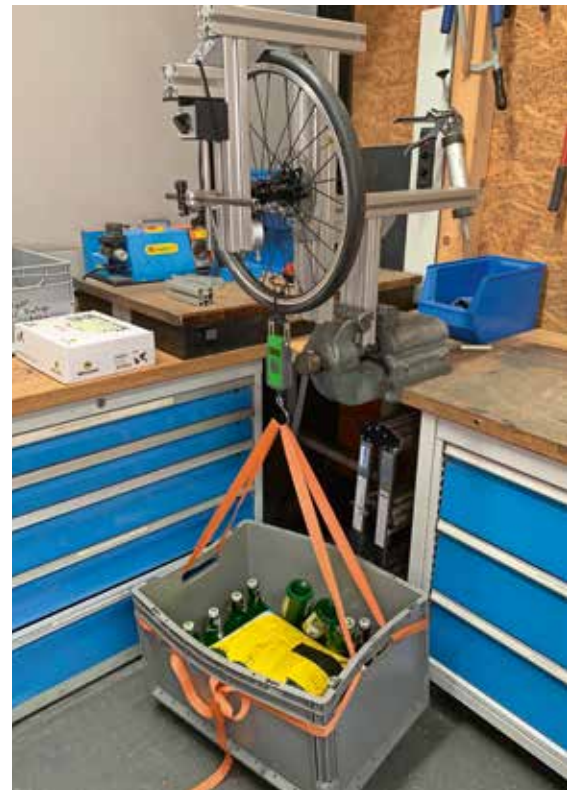
Belastungstest eines Radträgers mit einfachen Mitteln
