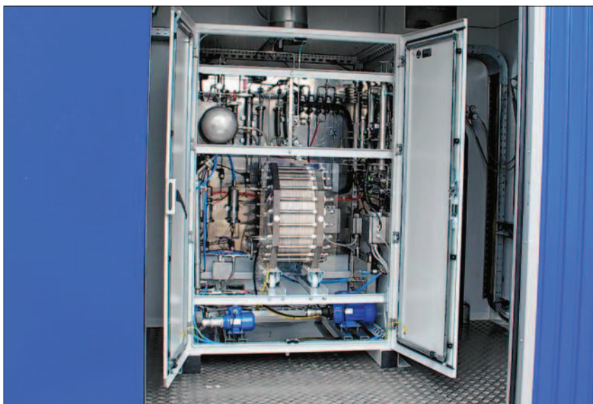
Die Hochschule Offenburg verfügt über einen Elektrolyseur, mit diesem wird Wasserstoff hergestellt.
