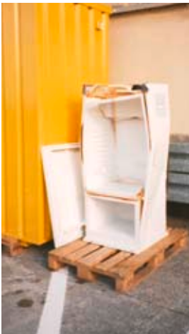
Bild 12: Folge der Verwendung eines nicht explosionsgeschützten Kühlschranks
