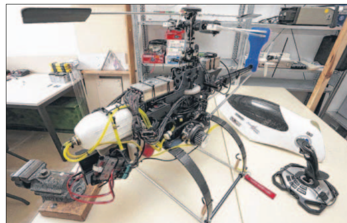
Sieben Kilo wiegt der Hubschrauber, rund vier Kilo kann er zuladen. Meist eine Kamera, um die Umgebung zu betrachten.
